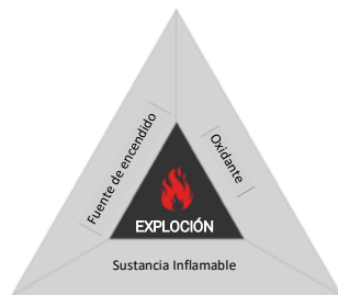
Figura 0: Los tres elementos necesarios para que se produzca una explosión
